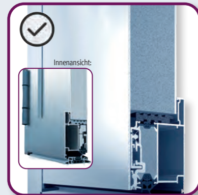
Außenansicht Aufsatzfüllung einseitig [Ud-Wert \leq 1,2 / m^2K ]
